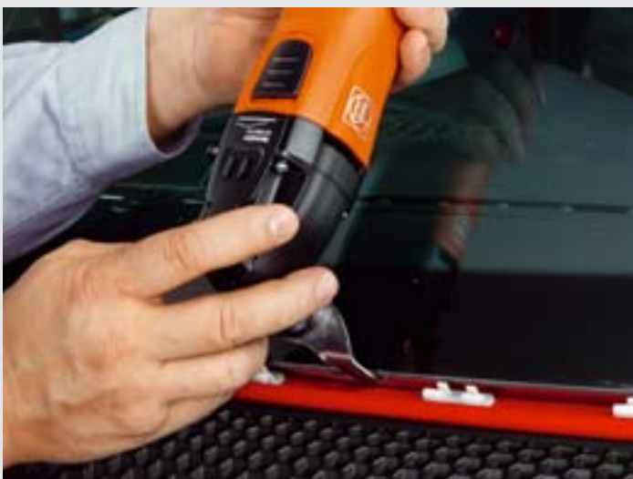
Für das Ausglasen unter der Motorhaube kommen die U-Messer zum Einsatz. Empfohlene Geschwindigkeit: Stufe 3 – 5.
